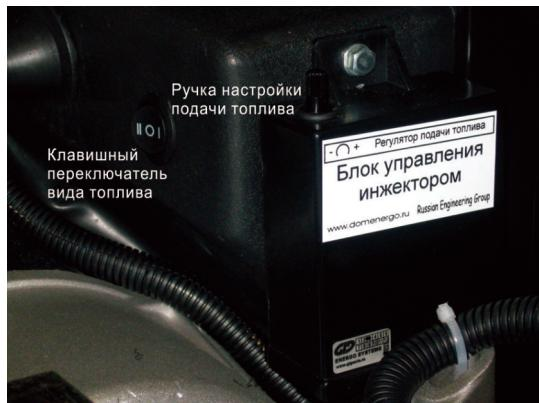
Клавишный переключатель вида топлива «МЕТАН/ПРОПАН» предназначен для переключения вида используемого топлива и имеет три положения, индицируемых соответствующим надписями на переключателе:
